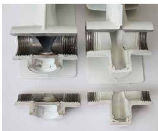
Сравнительный разрез конструкций
